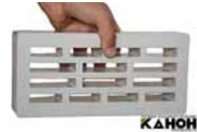
Рис. 4. Карбонатный кирпич. Марка 200; пустотность 40%; водопоглощение 7,5%; морозостойкость более 100
