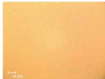
Рис. 4. Снимок наноллистов оксида графена на оптическом металлографическом микроскопе Альтами MET 5С
