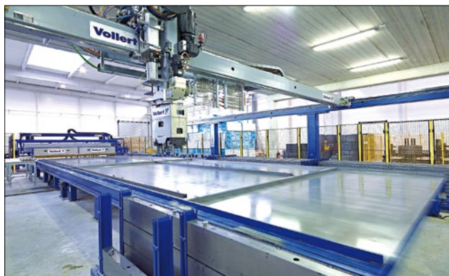
Опалубочный робот Smart Set
