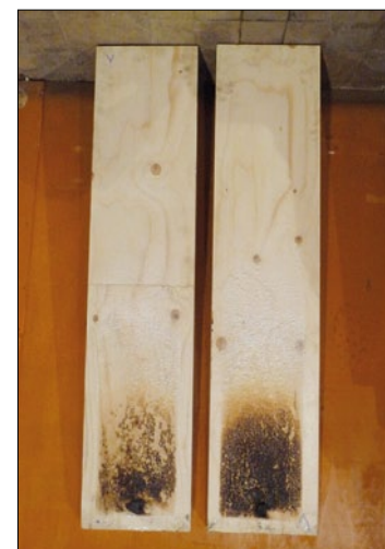
Рис. 10. Образцы ULTRALAM с огнезащитным покрытием Феникс ДП после испытаний на распространение пламени по ГОСТ Р 51032–97
