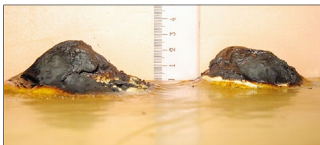
Рис. 1. Вспучивание огнезащитных покрытий при воздействии открытым пламенем
