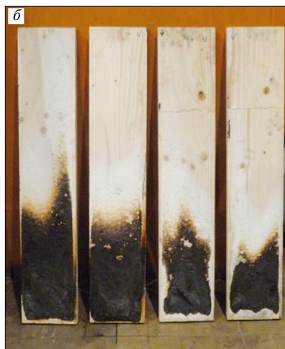
Рис. 9. Образцы ULTRALAM после испытаний на горючесть по ГОСТ 30244: а – без защитной обработки; б – с огнезащитным покрытием Феникс ДП
