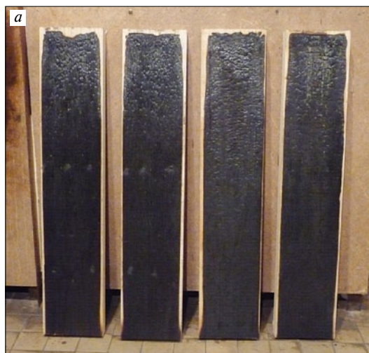
Рис. 9. Образцы ULTRALAM после испытаний на горючесть по ГОСТ 30244: а – без защитной обработки; б – с огнезащитным покрытием Феникс ДП
