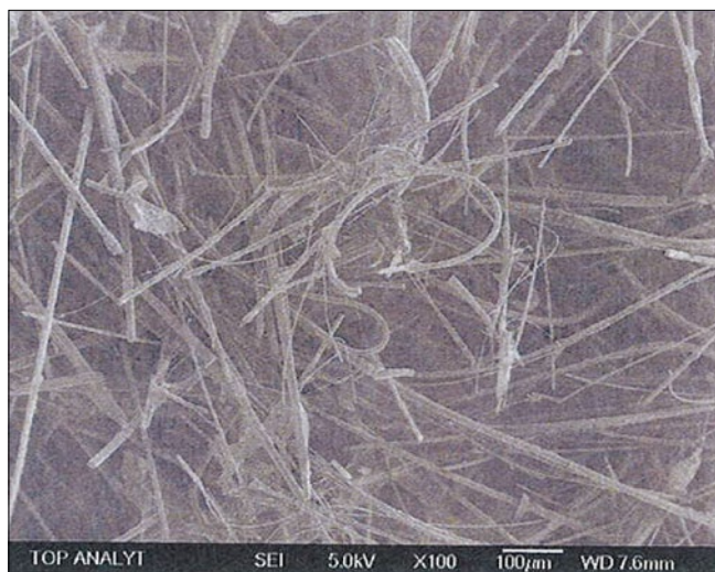
Рис. 6. Структура минераловатного утеплителя из базальтового волокна
