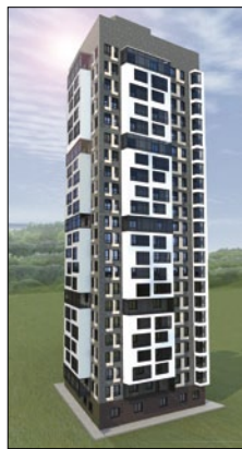
Рис. 6. Поэтажно-секционный метод проектирования позволяет отойти от системы типовых этажей и создавать различные варианты фасадов
