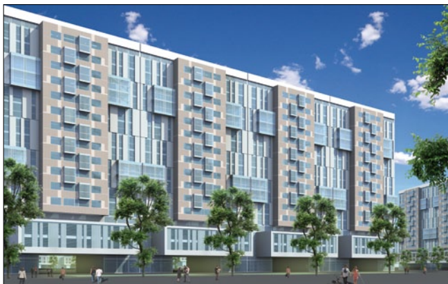
Рис. 6. Поэтажно-секционный метод проектирования позволяет отойти от системы типовых этажей и создавать различные варианты фасадов
