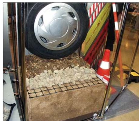
Дорожные сетки производства компании Протэкт укрепляют основания дорог, предупреждают проседание покрытия, экономят расход щебня
