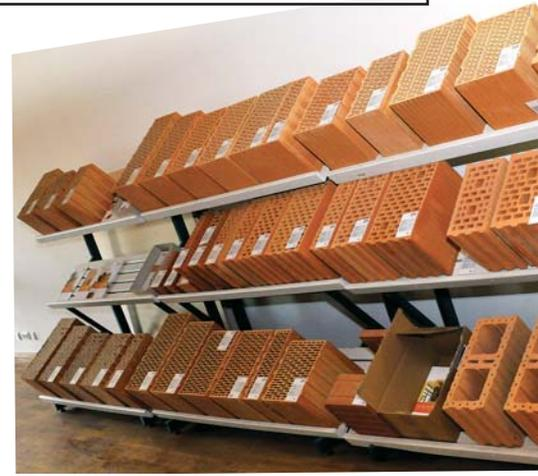
При содействии фирмы «Лингл» наша группа посетила завод «Leipfinger Boder», который в 2009 г. отметил свое 25-летие. Как и многие другие заводы Германии, он выпускает широкий ассортимент керамических поризованных стеновых и перегородочных блоков, облицовочный кирпич, керамические сборные надоконные перемычки.
