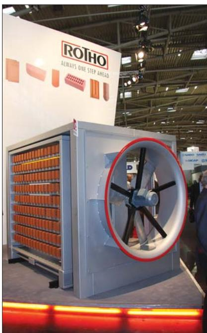
Более пятидесяти лет работает в керамической промышленности немецкая фирма **ROTHO**, которая специализируется в области сушки. На выставке фирма представила разработку 2009 г. – скоростную сушилку для кирпича X-Stream brick и сушилку с низким энергопотреблением EcoDry. Для равномерного распределения потоков воздуха в технологии X-Stream brick используются специальные сушильные вагонетки, на которые кирпич укладывается поперек направлению движения в один ряд.
