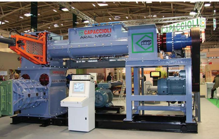
Известная итальянская фирма **Gruppo Capacciolli** дополнила линейку оборудования для керамической промышленности серий прессов ARAL. Их производительность варьируется от 25 до 90 т/ч. Конструкторы обеспечили оптимальное расположение всех органов, простой доступ к заменяемым частям и простоту инспекции наиболее важных узлов.
