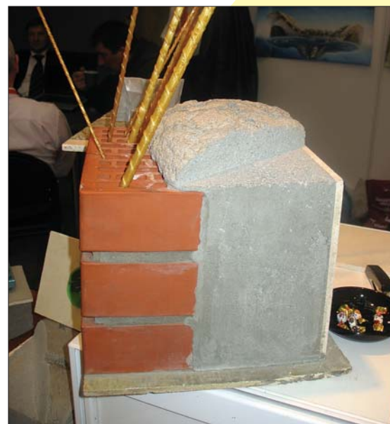
Строительная система «Быстрая стена» может включать наружный слой из кирпича, наполнитель из растущего газобетона и Эко-Листа в качестве внутреннего слоя
