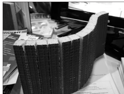
Разработка фирмы «Плитонит» – материал, состоящий из полимерцементных композиций, наносимых на стеклосетку и служащих опалубкой для внутреннего слоя из ППУ. Новый материал может быть использован для создания криволинейных поверхностей
