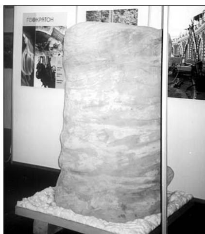
Компания «Геократон» специализируется в области грунтовых оснований и фундаментов, других подземных конструкций, в том числе памятников архитектуры. На своем стенде компания продемонстрировала образец грунтоцементной сваи
