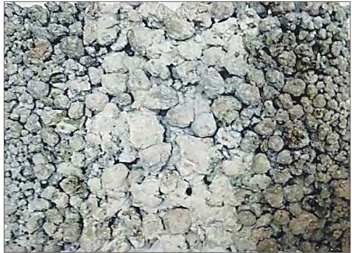
Рис. 3. Модель многослойной структуры стенового блока из крупнопористого легкого бетона на гранулированных заполнителях с дискретным изменением плотности слоев
