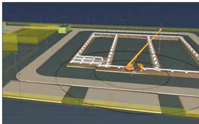
Рис. 5. Производство работ на этапе нулевого цикла Fig. 5. Production of works at the stage of the zero cycle
