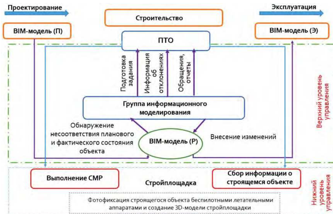
Рис. 2. Схема оперативного управления ходом строительного процесса с помощью BIM-модели Fig. 2. Scheme of operational management of the construction process using a BIM model
