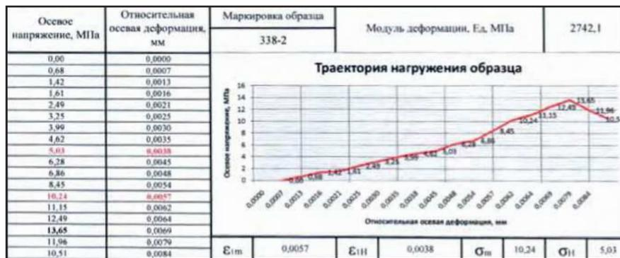
Рис. 6. График испытаний образца грунтоцемента при определении модуля деформации
