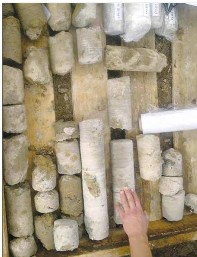
**Рис. 5.** Образцы выбуренных кернов – грунтоцемент
