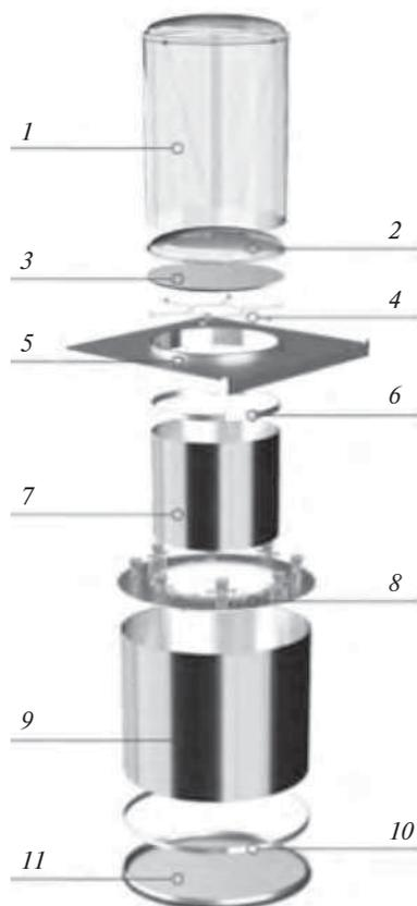
**Рис. 4.** Гибридный осветительный комплекс (ГОК) Solar LED-S на базе ПТС Solatube® M74: 1 – коллектор ПТС Solatube® M74 серии SkyVault; 2 – внешний купол; 3 – внутренний защитный купол; 4 – элемент защиты от проникновения; 5 – бордюрный флешинг; 6 – кольцо фиксации световода; 7 – световод верхней ступени оптического каскада; 8 – светодиодный блок искусственного света (СБИС); 9 – световод нижней ступени оптического каскада; 10 – кольцо для фиксации рассеивателя; 11 – призматический рассеиватель
