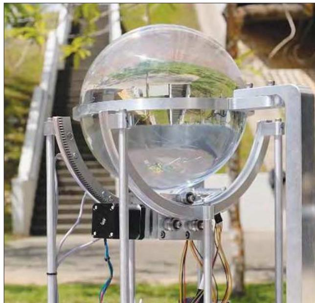
**Рис. 1.** Установка для подачи солнечного света в подземные вспомогательные помещения (разработка Наньянского технологического университета в Сингапуре)
