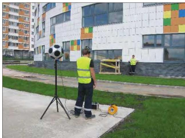
**Рис. 2.** Проведение натурных испытаний по определению звукоизоляции наружных светопрозрачных ограждающих конструкций у фасада здания
