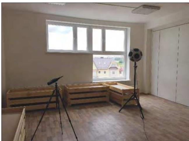
**Рис. 1.** Проведение натурных испытаний по определению звукоизоляции наружных светопрозрачных ограждающих конструкций в помещении с низким уровнем звукового давления
