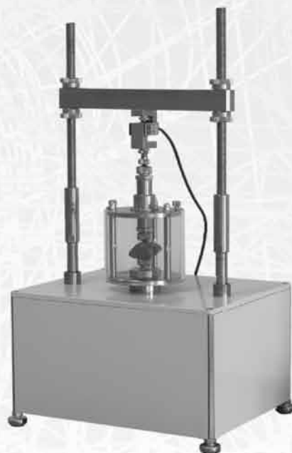
Установка для испытаний методом одноосного растяжения
