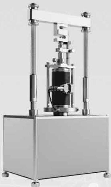
Установка для испытаний методом одноосного сжатия
