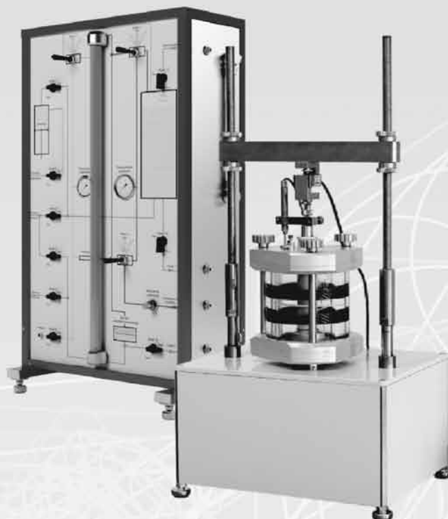
Установка для испытаний методом одноосного растяжения
