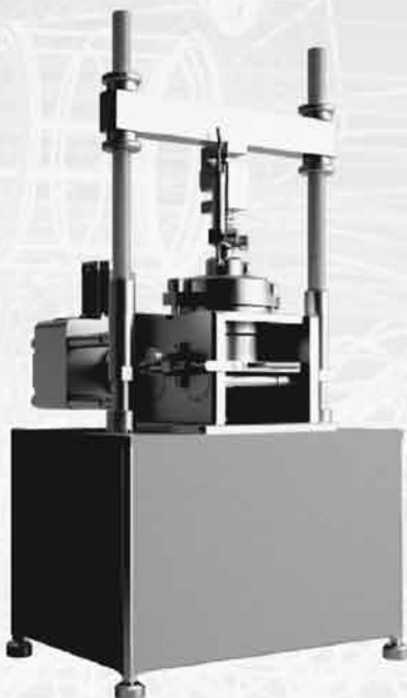
Установка для испытаний методом сдвига
