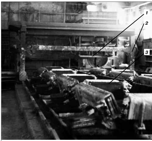
Рис. 3. Технологическая линия по производству гипсовых стеновых материалов с модулем УТМ-1 (Москва, 90-е гг.): 1 – смеситель-активатор; 2 – самоходный бетоноукладчик; 3 – формы
