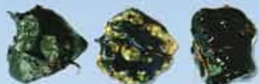
До кипячения (битум без добавки) После кипячения (битум без добавки) После кипячения (битум с добавкой «ДАД-1»)
