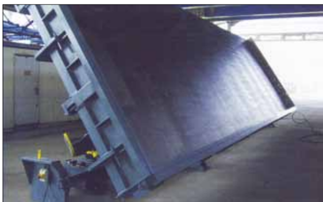
Рис. 1. Технологический стол с жесткой конструктивной сварной рамой, внутренней системой обогрева и силовой гидравликой для поворота в вертикальной плоскости или опрокидывания
