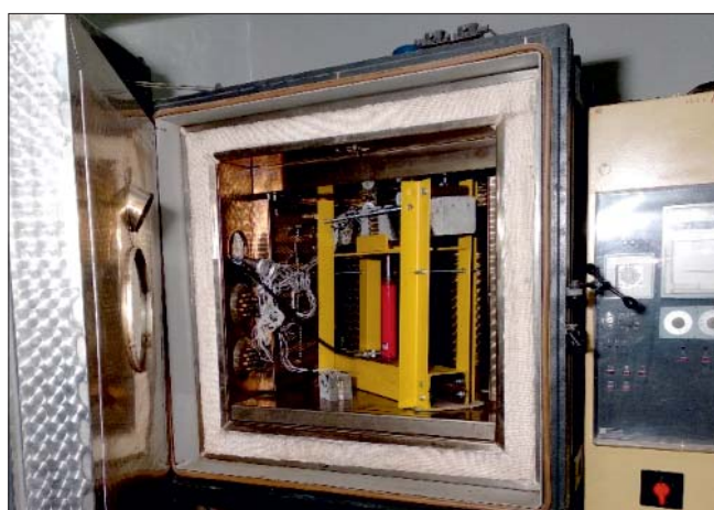
Рис. 3. Фото испытательного стенда на ползучесть, установленного в термовакуумной камере STBV-1000-IV (ILKA)
