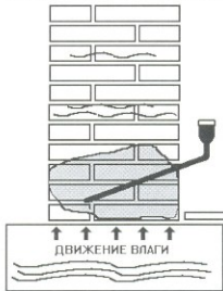
Принципиальная схема ликвидации капиллярного поднятия влаги с помощью эмульсии «Кемасол»
