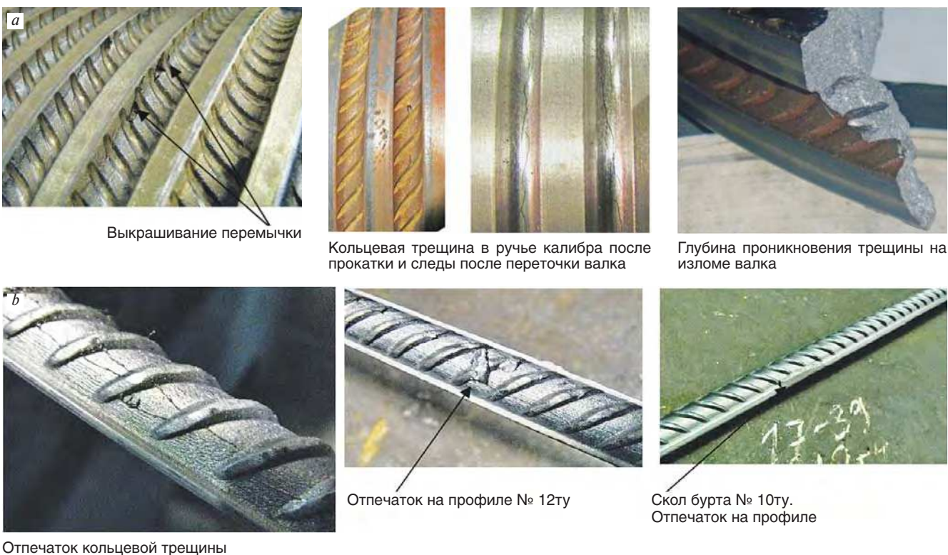
Рис. 3. Вид дефектов на поверхности калибров ( a ) и готовом профиле ( b ) Fig. 3. Type of defects on the calibers surface ( a ) and the finished profile ( b )
