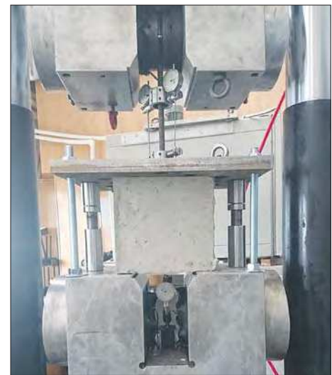
Рис. 9. Испытания сцепления с бетоном винтовой арматуры ( d = 16 мм, заделка в бетоне 5d, прочность бетона 72,2 МПа): 1 – класса Av500 (аналог GEWI-Stahl), f_R = 0,091 , с двухрядным профилем; 2 – класса Av500P, f_R = 0,072 , с четырехрядным профилем
