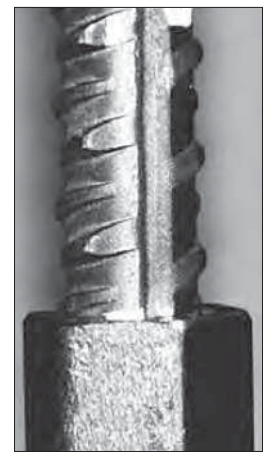
Рис. 8. Механические испытания винтовой арматуры: a – двухрядной (аналог GEWI-Stahl); b – четырехрядной (Av500P) Fig. 8. Mechanical tests of screw fittings: a – two-row (analog GEWI-Stahl); b – four-row (Av500P)
