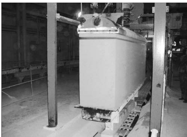
Рис. 5. Снятие верхнего подрезного слоя
