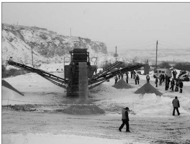
Участники конференции знакомятся с работой самоходных дробильно-сортировочных агрегатов фирмы «ТЕРЕКС | Финлейн» на Михайловском КСМ
