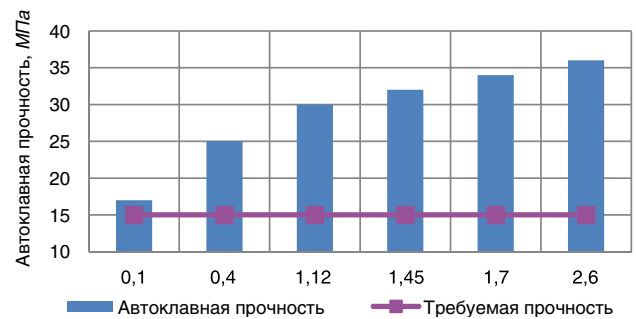
Рис. 8. Влияние крупности песков на автоклавленную прочность в технологии с использованием извести с добавкой песка (ИКВ)
