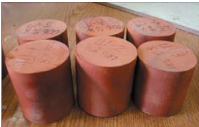
Рис. 6. Обожженные образцы и кирпич на основе ТПУ
