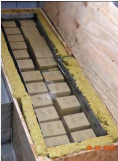
Рис. 3. Образцы кирпича в ванне с водой при температуре 69–72°C
