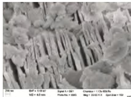
Рис. 7. РЭМ изображение модификатора X – высокодисперсного отхода очистки фильтров завода стекловолокна
