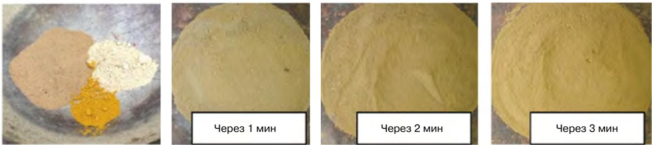
**Рис. 2.** Изменение цвета негашеной формовочной смеси при вводе желтого пигмента
