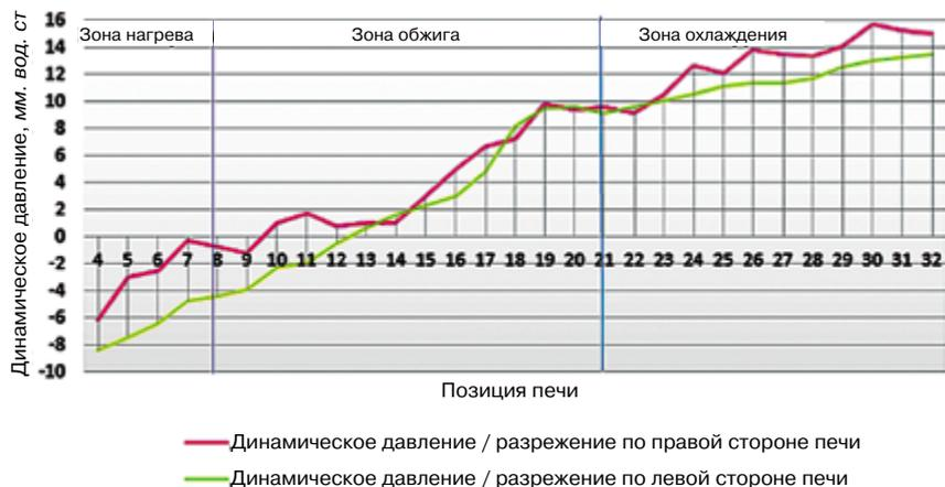
Рис. 3. Изменение динамического давления/разрежения среды по зонам рабочего пространства печи МК-76
