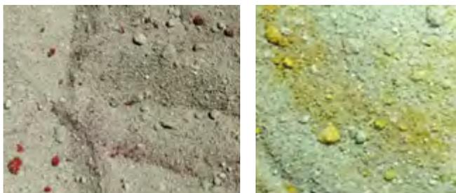
Рис. 7. Образование шарообразных пигментных конгломератов в гашеной смеси
