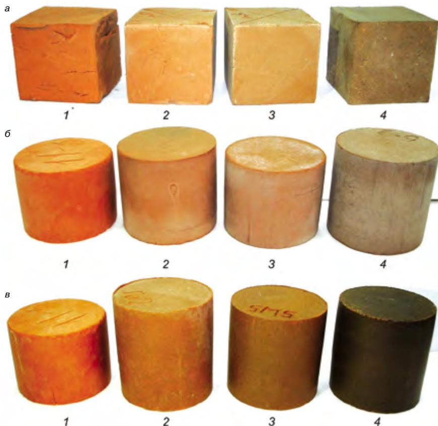
Рис. 1. Окрашивание керамических образцов из суглинка, изготовленных способом пластического формования (а); полусухого прессования (б); компрессионного формования опудренных гранул (в): 1 – без добавки; 2, 3, 4 – с добавкой ОМР соответственно в количестве 2, 5, 10 мас. %
