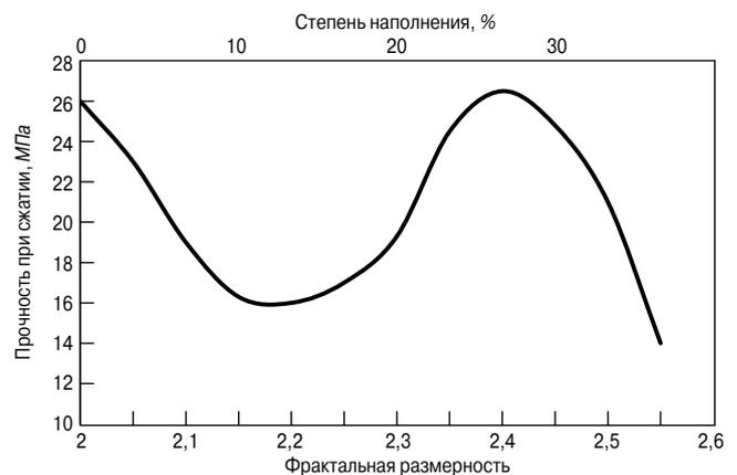
Рис. 4. Зависимость между фрактальной размерностью и прочностью при сжатии [11]
