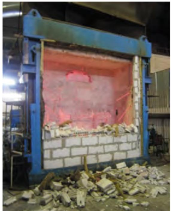
Рис. 2. Фрагмент стены из кладочных изделий на основе модифицированного силикатобетона после проведения испытания на огнестойкость
