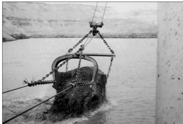
Ковш драглайна емкостью 11 м 3 конструкции ВНИПИИстромсырье, обеспечивающий увеличение выемки породы при разработке подводного забоя на 20%. Глубина подводного забоя 18 м. ОАО «Доломит» (фото Г.Р. Буткевича)
