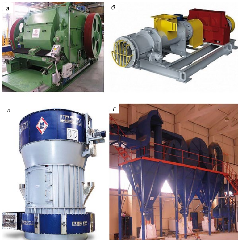
Рис. 1. Оборудование для тонкого помола и механоактивации глинистого сырья. а – высокоскоростные прокатные валцы тонкого помола LVP (Bedeschi, Италия); б – установка глубокой переработки глины «Каскад-14» («ИНТА-строй», Россия); в – маятниковая мельница Molomax 6-500 (Manfredini&Schianchi, Италия); г – измельчительно-сушильная установка («Баскей», Россия)
