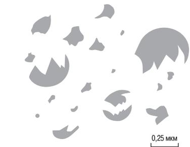
Рис. 2. Микрокремнезем после механоактивации
