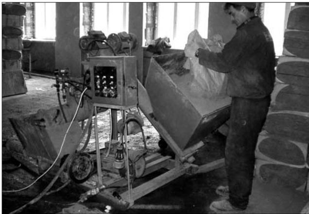
Рис. 3. Мобильный пенобетоносмесительный комплекс МПБСК-2
