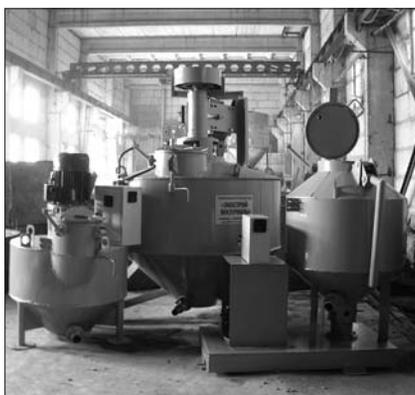
Рис. 1. Пенобетономесители СПБУ-250М, СПБУ-1000М и СПБУ-250 (слева направо)
