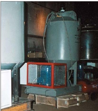
Рис. 1. Турбулентный смеситель с активатором
