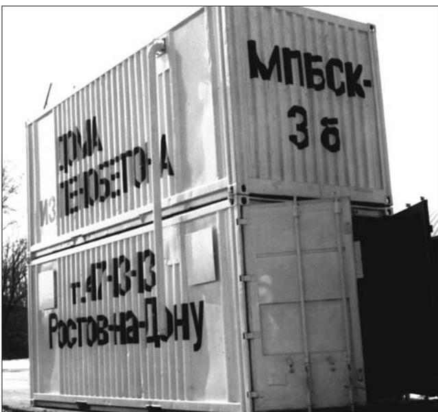
Рис. 4. Мобильный пенобетоносмесительный комплекс МПБСК-3б
