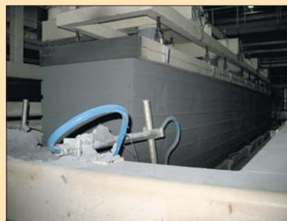
Специальные машины не только нарезают массив на блоки заданного размера, но одновременно фрезеруют пазы-гребни на торцах блоков, а также захватные карманы для рук
