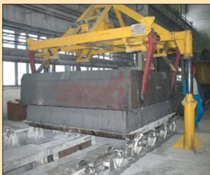
После вспучивания и предварительного твердения массива форма снимается
