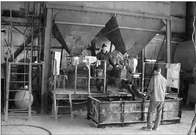
Рис. 2. Стационарный пенобетоносмесительный узел
