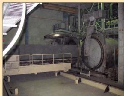
Поезд из шести тележек загружается в автоклав длиной 37 м, где при давлении 12 атм и температуре 180°C происходит твердение бетона
