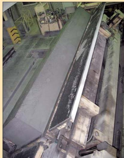
Технология фирмы «WEHRHANN» имеет ряд отличительных особенностей. После формования, выстаивания и распулочки массива его кантуют на 90°, устанавливая на ребро
