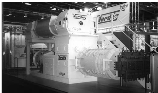
На стенде испанской фирмы «Verdes» был представлен вакуум-пресс с отдельным приводом смесителя и экструдера, это обеспечивает высокую надежность и производительность до 100 т/ч
