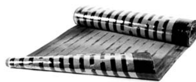
Материалы Унифлекс «Вент» и Техноэласт «Вент» обеспечивают распределение водяных паров под кровельным ковром
