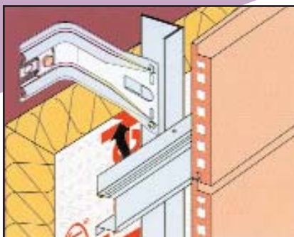
Невидимое крепление клинкерной плитки
