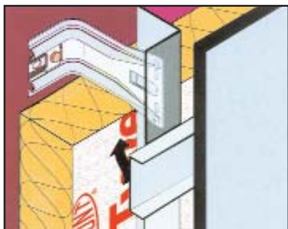
Невидимое крепление керамогранита и натурального камня
