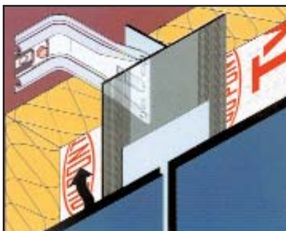
Невидимое (на клей) крепление пластиковых панелей типа «MAX»
