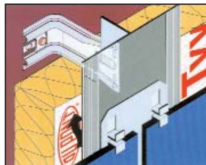
Видимое (на клямерах) крепление керамогранита
