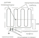
Рис. 4. Схема укладки нагревательного кабеля «Теплолюкс»
