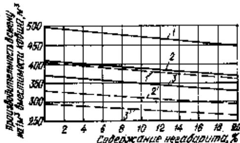
Рис. 1. Зависимость выработки на 1 м 3 вместимости ковша от содержания негабарита, категории породы по трудности экскавации и размера ковша экскаватора при нормативных условиях экскавации
