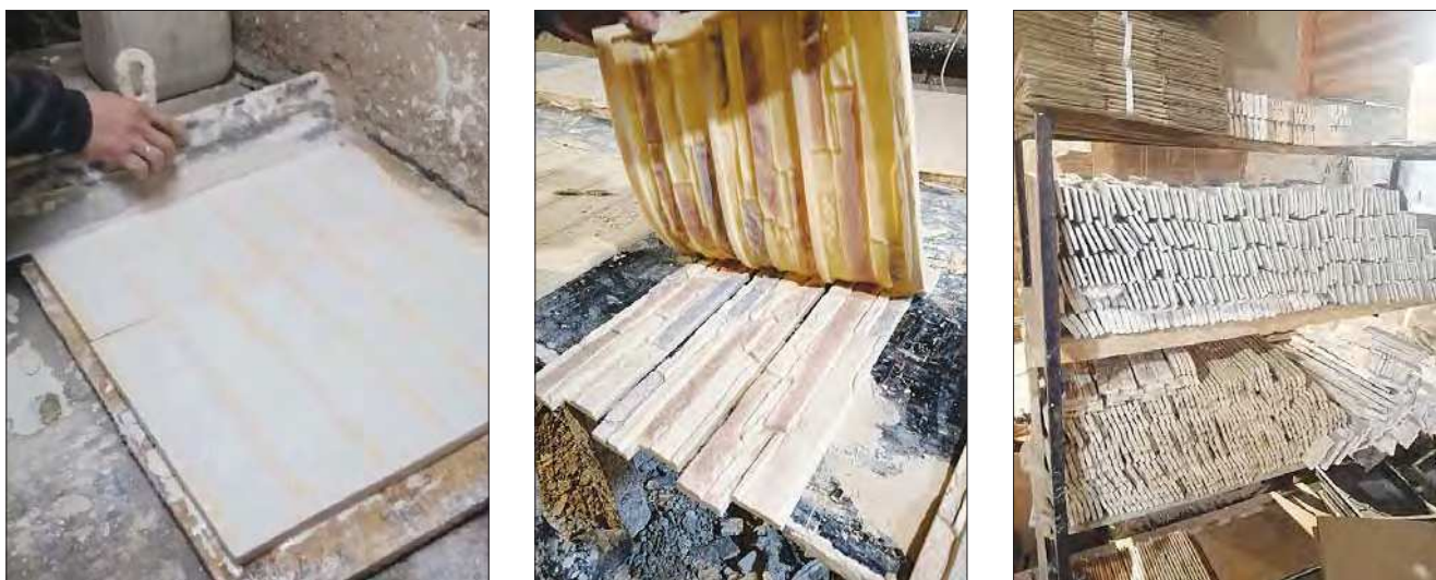
Рис. 4. Изготовление декоративного камня из фторангидрито-гипсовой композиции Fig. 4. Making a decorative stone from a fluoroanhydrite-gypsum composition
