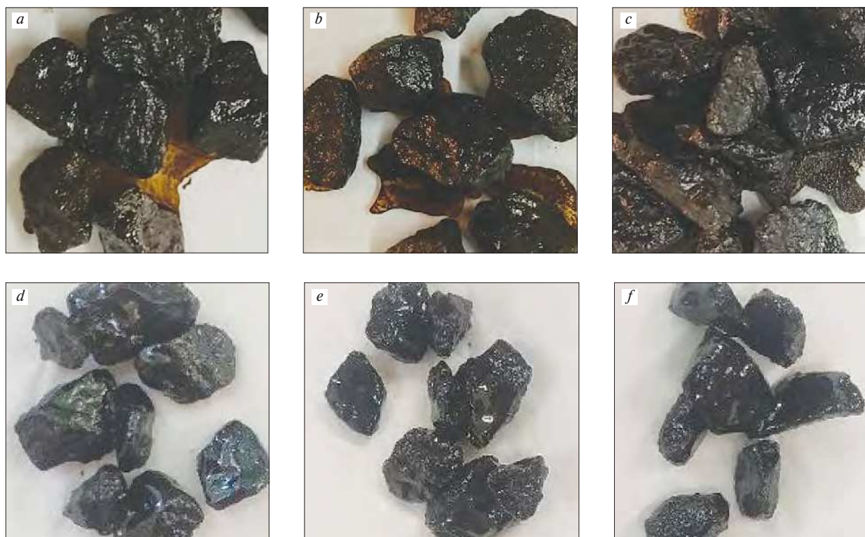
Рис. 3. Адгезия битумных эмульсий, модифицированных золами-уноса, к поверхности крупного заполнителя: a – ЭБДК С; b – ЭБДК С + зола-уноса Троицкой ГРЭС; c – ЭБДК С + зола-уноса Рефтинской ГРЭС; d – ЭБДК М; e – ЭБДК М + зола-уноса Троицкой ГРЭС; f – ЭБДК М + зола-уноса Рефтинской ГРЭС
