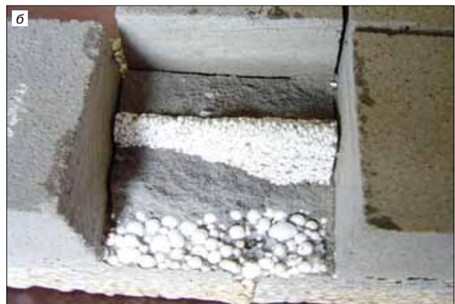
Рис. 3. Поверхности отрыва газобетона от полистирола без устройства шип-паз (а) и с устройством шип-паз (б)
