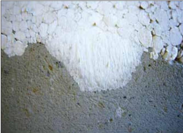
Рис. 2. Двухслойный полистиролгазобетон с соединением газобетона с полистиролом типа «шип-паз»
