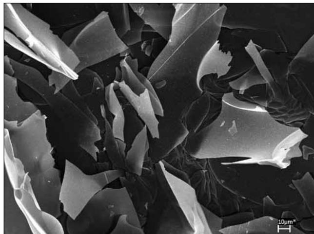
Рис. 4. Фрагмент структуры вспученной щелочно-силикатной сырьевой смеси, содержащей 5% бору
