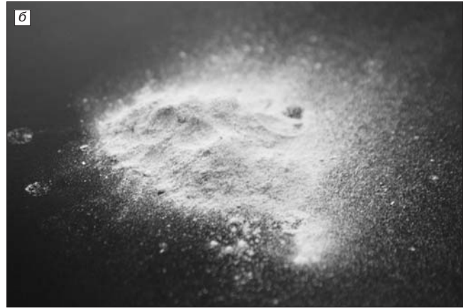
Рис. 2. а – исходный материал – опилки, сучья, ветки \varnothing 30 мм, длина до 20 мм; б – материал после измельчения на импеллерной мельнице «МИКРОКСИЛЕМА»
