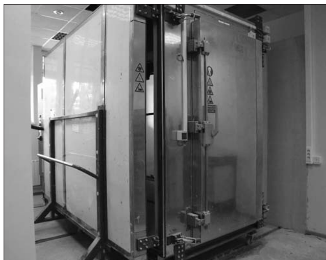
Рис. 6. Мобильный стенд климатических испытаний ограждающих конструкций
