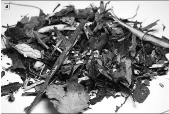
Рис. 2. а – исходный материал – опилки, сучья, ветки \varnothing 30 мм, длина до 20 мм; б – материал после измельчения на импеллерной мельнице «МИКРОКСИЛЕМА»
