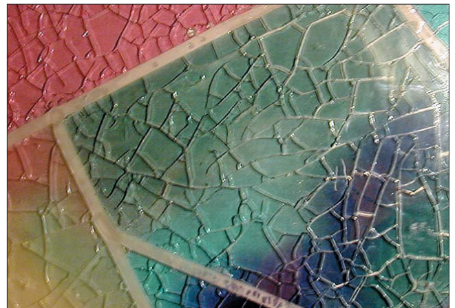
Рис. 2. Фрагмент светопрозрачного многослойного декоративного изделия с деструктурированным слоем гидрогеля кремнезема
