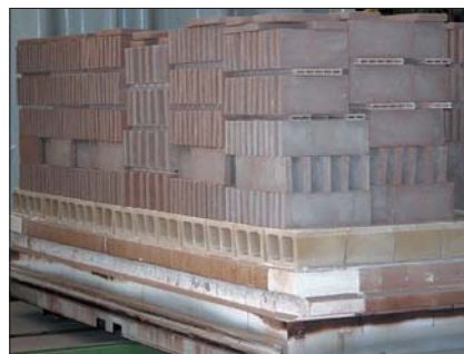
Печь периодического действия фирмы «CERIC» допускает высокую плотность садки
