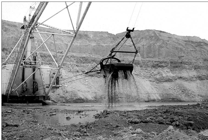
Добыча доломита из-под воды экскаватором ЭШ 10/70 с ковшом емкостью 11 м 3 конструкции ВНИПИИстромсырье. Фото автора
