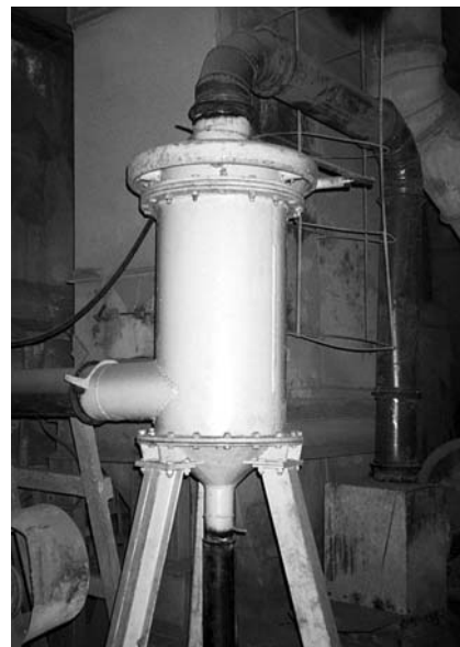
Рис. 3. Фильтровальный аппарат для тонкой очистки воздуха от механических примесей
