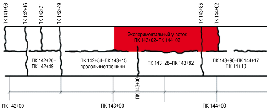
Рис. 3. Схема распространения поперечных и продольных трещин на участке автомобильной дороги Чита–Хабаровск на 365 км (ПК 142+00 – ПК 144+02). Обследование 2009 г.
