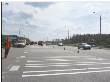
Рис. 2. Внешний вид участка сравнительных полевых испытаний 2012–2013 гг. после нанесения контрольных линий 22.05.2012 г.
