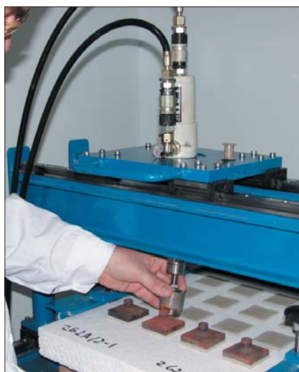
Технический центр WACKER оснащен современным испытательным лабораторным оборудованием (слева направо): прибор для измерения прочностных показателей; отрывная машина для определения эффективности клеевого состава; камера для испытания образцов на количество циклов замораживания-оттаивания
