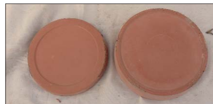
Рис. 5. Образцы из бетона для отделочного слоя с микрокремнеземом (справа) и без него (слева)
