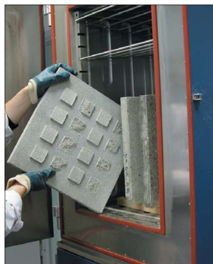
Технический центр WACKER оснащен современным испытательным лабораторным оборудованием (слева направо): прибор для измерения прочностных показателей; отрывная машина для определения эффективности клеевого состава; камера для испытания образцов на количество циклов замораживания-оттаивания
