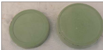
Рис. 5. Образцы из бетона для отделочного слоя с микрокремнеземом (справа) и без него (слева)
