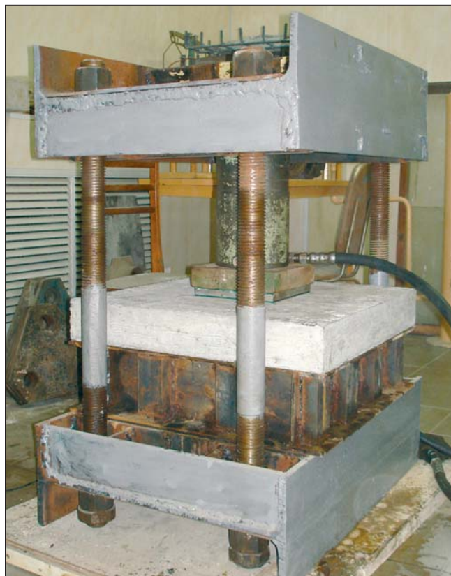
Рис. 1. Общий вид испытания железобетонных плит на продавливание
