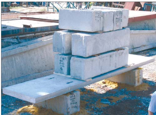
Рис. 3. Общий вид испытания дорожной дисперсно-армированной плиты
