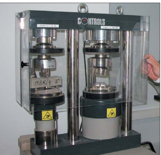
Технический центр WACKER оснащен современным испытательным лабораторным оборудованием (слева направо): прибор для измерения прочностных показателей; отрывная машина для определения эффективности клеевого состава; камера для испытания образцов на количество циклов замораживания-оттаивания
