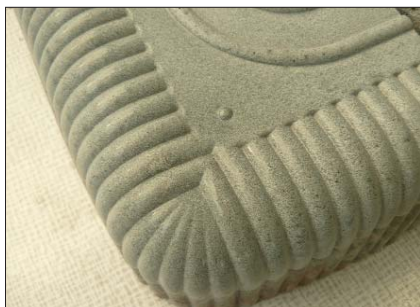
Рис. 4. Фрагмент образца, изготовленного в стеклопластиковой форме
