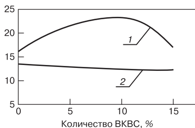
Рис. 1. Закономерности изменения физико-механических характеристик экспериментальных образцов автоклавного материала от количества ВКВС: 1 — предел прочности при сжатии, МПа; 2 — водопоглощение, %
