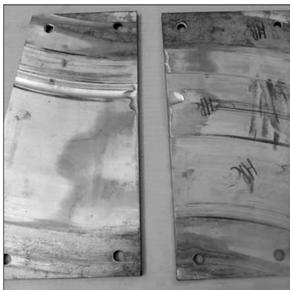
Рис. 6. Пластины контрштампа с характерными следами от воздействия торцевых пластин
