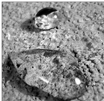
Рис. 6. Поверхность керамического кирпича, обработанная смесью на основе гидрофобизированного портландцемента и крупнопористого наполнителя (песок фракции 1–2 мм)
