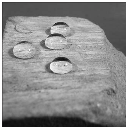
Рис. 5. Капли воды на поверхности образца из гидрофобизированного портландцемента
