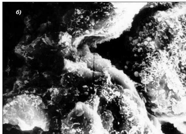
**Рис. 2.** Начальные кристаллизационные контакты между частицами в образце суглинка  $dQ_{III}$ , обработанном: а – 2,5 н.; б – 5 н. раствором NaOH
