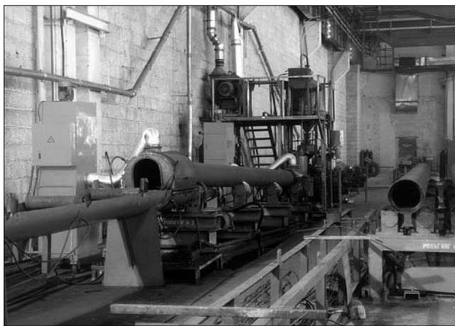
Линия термодиффузионного оцинкования арматурной стали, металлопроката и труб на ООО «Термоанткор» ОАО «КПД»
