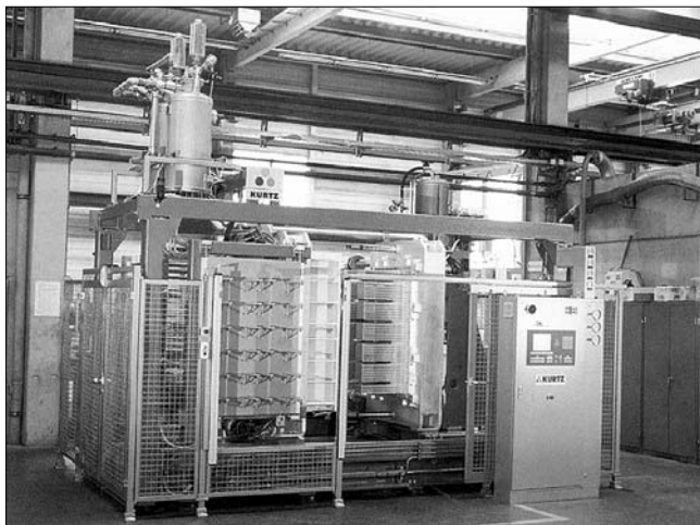
Рис. 1. Формовочный автомат К 138R с паровой камерой карусельного типа
