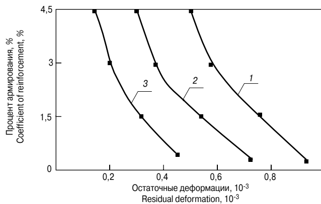
Рис. 2. Остаточные деформации сталефибробетона после тепловой обработки: 1 – состава с цементно-песчаным отношением 1:1; 2 – состава с цементно-песчаным отношением 1:1,5; 3 – состава с цементно-песчаным отношением 1:3
