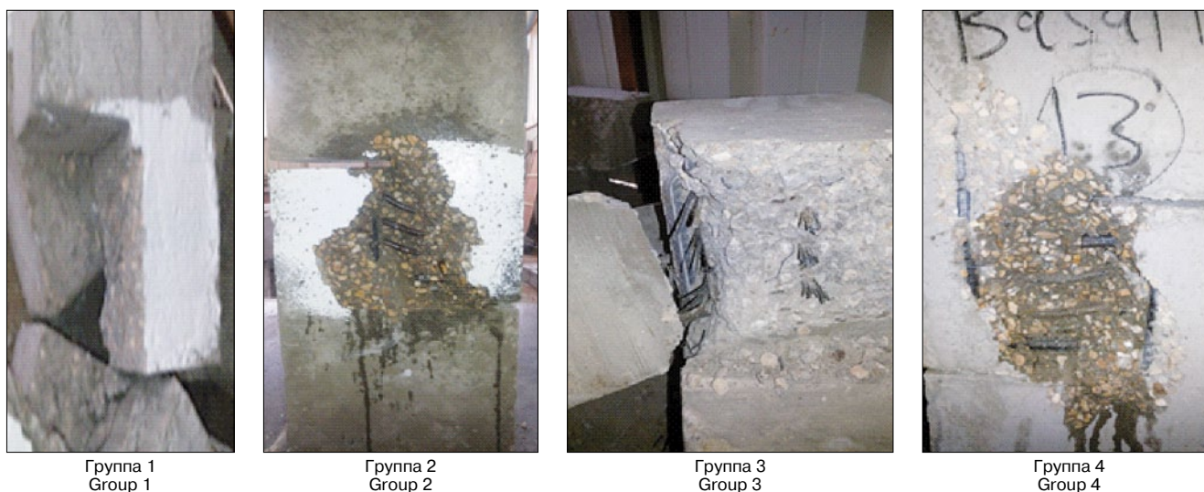
Рис. 4. Плоскость сдвига после разрушения
