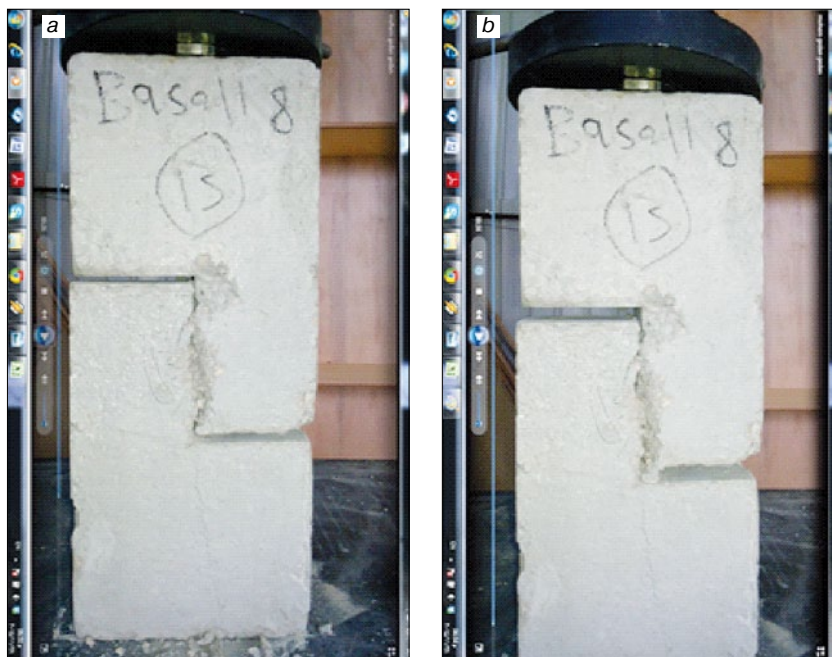
Рис. 6. Смещение деформации базальтового образца диаметром 8 мм: а – при нагрузке; б – при разгрузке
