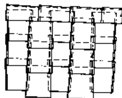
Рис. 3. Фрагмент покрытия из лотковой черепицы
