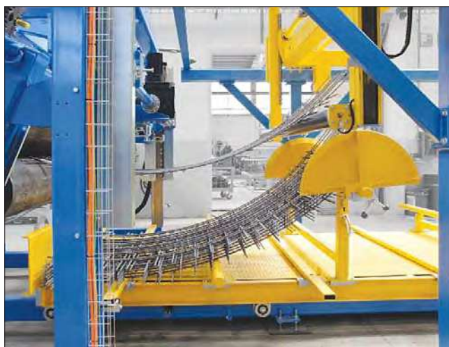
Устройство для сворачивания в рулоны позволяет загибать армосетки вверх или вниз
