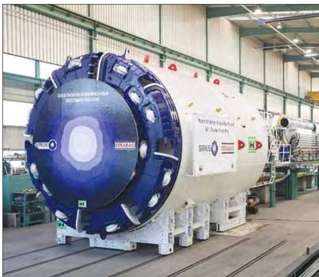
Тоннелепроходческий щит S-1175 компании Strabag AG
