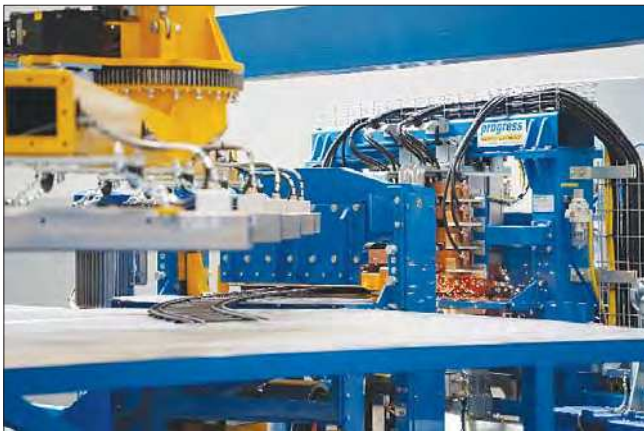
Автомат Tunnel Master оснащен компьютерным управлением для сварки изогнутых тоннельных сегментов
