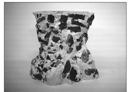
Рис. 2. Образец № 6 (серозольный щебень, пропитанный модифицированной серой) после разрушения
