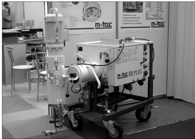
Рис. 4. Современная штукатурная машина DUO-MIX PLUS может готовить раствор из смесей, упакованных в мешки или доставленных на стройку в силосах
