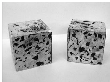
Рис. 1. Образцы № 6, № 8. Щебень серозольный и серохвостовой, фракции 10–20, залитый модифицированной серой
