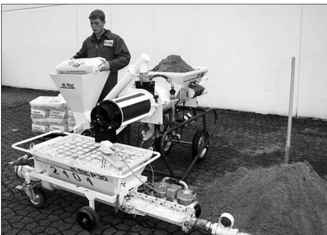
Рис. 1. Машина СО-MIX позволяет точно дозировать и смешивать необходимое количество вяжущего и влажного песка и подавать смесь к месту нанесения
