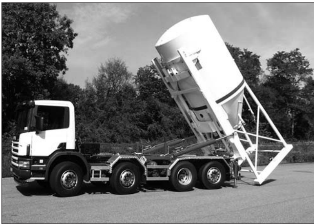
Рис. 3. Специальный силос для сухих строительных смесей можно транспортировать автомобилем к месту строительства
