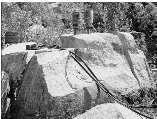
Рис. 2. Разрушение блоков гранита («негабарита») с использованием одновременно двух ЭВУ
