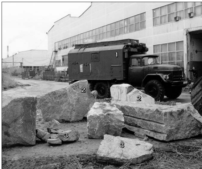
Рис. 1. Общий вид МЭРУ и разрушенных блоков горных пород. 1 – МЭРУ; 2 – блоки горных породы (гранит, мрамор); 3 – куски, отделенные от блоков с применением МЭРУ
