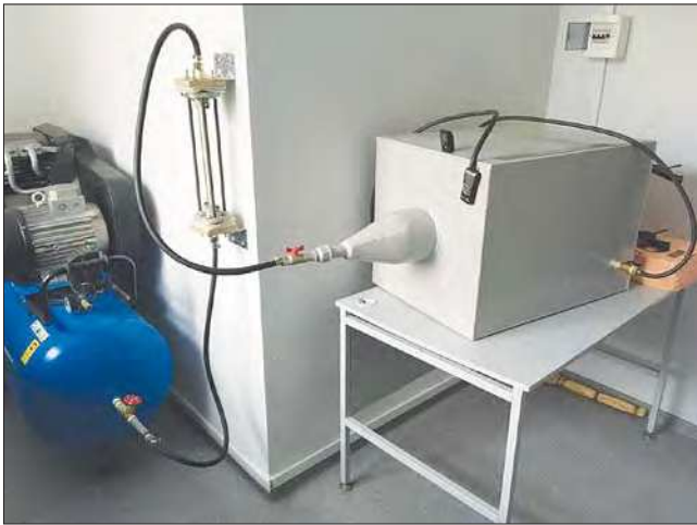
Рис. 2. Экспериментальная установка по определению воздухопроницаемости
