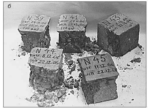
Рис. 4. Партия опытных образцов. а – до испытаний на механическую прочность; б – после испытаний
