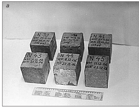
Рис. 4. Партия опытных образцов. а – до испытаний на механическую прочность; б – после испытаний
