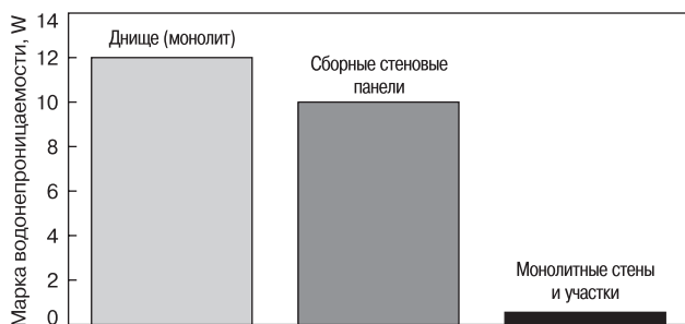
Водонепроницаемость бетона пожарных бассейнов
