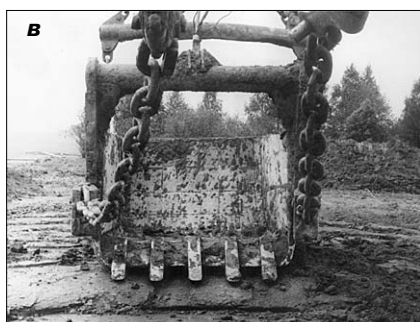
Рис. 1. Применение ППФП на рабочих поверхностях: а – перегрузочной воронки; б – накопительного бункера; в – ковша экскаватора; г – кузова самосвала; д – думпкара
