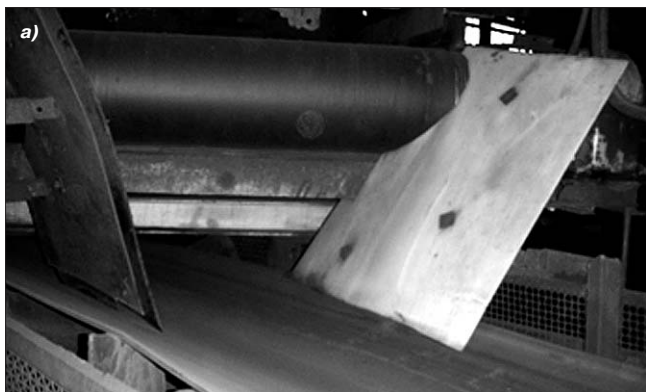
Рис. 1. Применение ППФП на различных видах оборудования: а – на стенках бункера МГОК; б – на полимерном плужковом сбрасывателе
