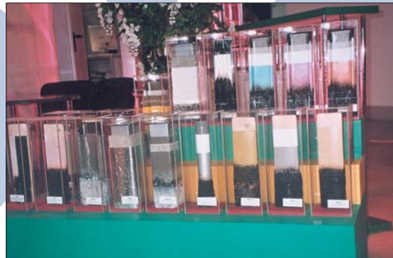
На стенде Ассоциации «Крилка» была представлена коллекция образцов, обработанных огнезащитными составами и прошедших огневые испытания
