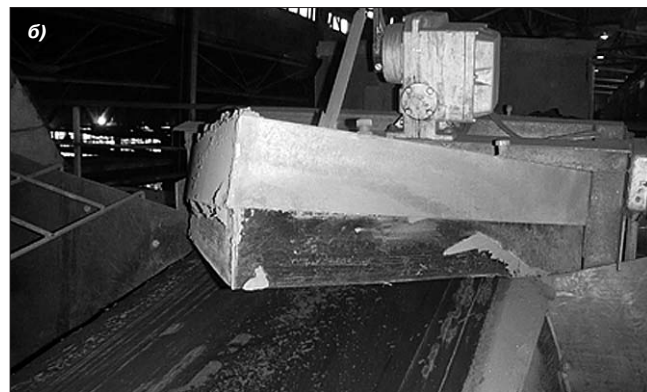
Рис. 1. Применение ППФП на различных видах оборудования: а – на стенках бункера МГОК; б – на полимерном плужковом сбрасывателе
